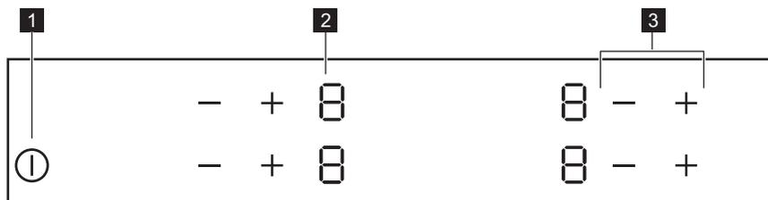
Ракувајте со апаратот со помош на сензорските полиња. Екраните, показателите и звуците покажуваат кои функции работат.
