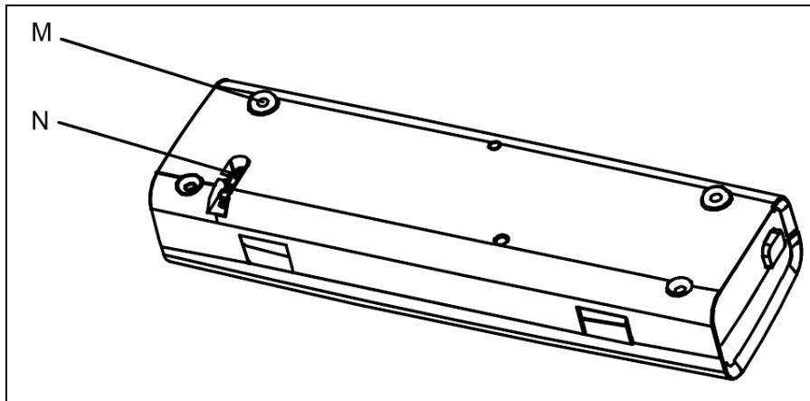
**M. SILIKONSKA PODLOGA****N. IZLAZNI OTVOR ZA STRUJNI KABEL****kako napraviti vrećice prilagođene veličine**
