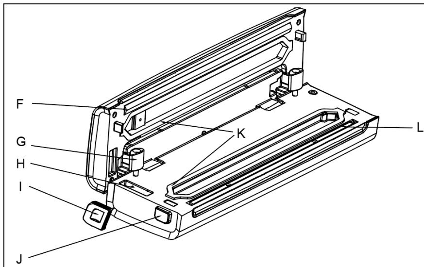
**F. SILIKON ZA BRTVLJENJE****G. ADAPTER ZA PRIKLJUČAK CRIJEVA PRI VAKUMIRANJU NAMIRNICA U POSUDI**
