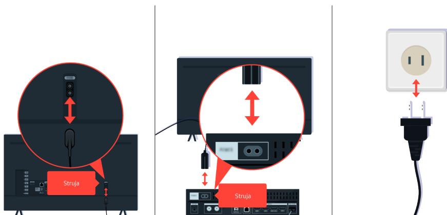
Prvo isključite pa ponovno priključite kabele napajanja i HDMI kabele na stražnju stranu televizora i uređaj One Connect (OC), zatim isključite kabel napajanja i ponovno ga uključite u zidnu utičnicu.
