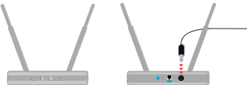
Pobrinite se da je vaša pristupna točka povezana s internetom. Ako nije, možda će biti potrebno isključiti i ponovno uključiti njen kabel napajanja.
