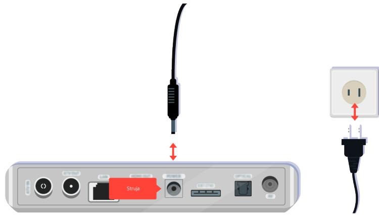
Ako se ne uključi, provjerite je li kabel napajanja ispravno povezan s uređajem i utičnicom na zidu.
