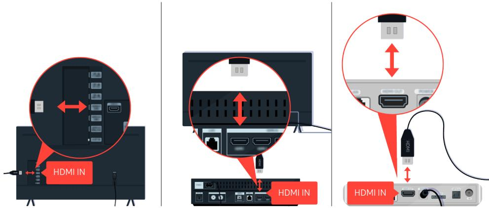
Prvo isključite pa ponovno priključite kabele napajanja i HDMI kabele na stražnju stranu televizora i uređaj One Connect (OC), zatim isključite kabel napajanja i ponovno ga uključite u zidnu utičnicu.
