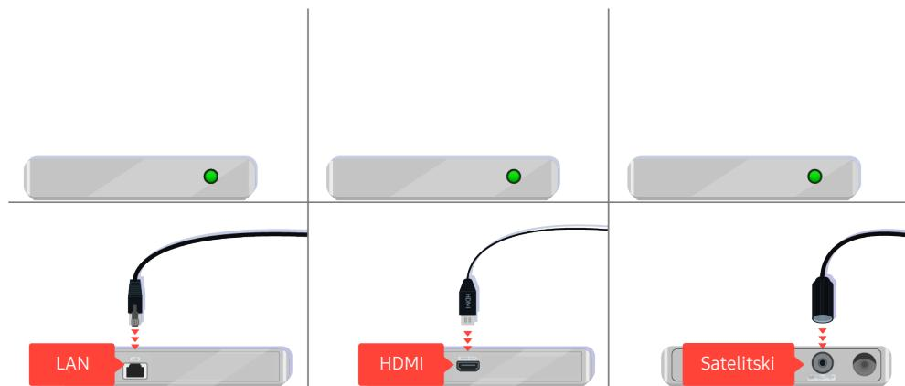
Ako upotrebljavate set-top box prijemnik, provjerite kabelske priključke. Kabel koji trebate povezati ovisi o vrsti set-top box prijemnika.
