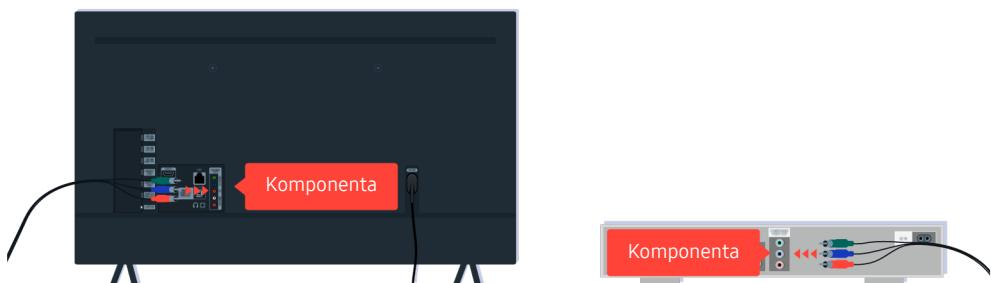
Ako se upotrebljava komponentni kabel, pobrinite se da su obojani priključci povezani s odgovarajućim priključcima na vanjskom uređaju i televizoru.
