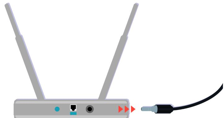
Pokušajte ponovno pokrenuti pristupnu točku isključivanjem i ponovnim uključivanjem priključka napajanja. Nakon ponovnog pokretanja možda će biti potrebna jedna do dvije minute da se pristupna točka ponovno poveže s mrežom.
