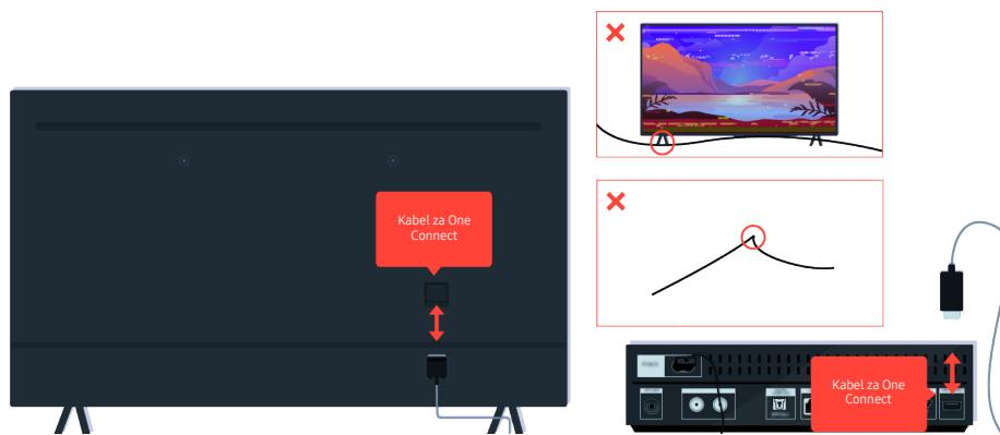
Ako se problem nastavi i ako vaš televizor upotrebljava Kabel za One Connect, odspojite i ponovno spojite kabel Kabel za One Connect na televizor i uređaj One Connect (OC). Pobrinite se da kabel Kabel za One Connect nije priklješten ili jako savijen.
