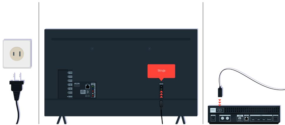
Ako senzor daljinskog upravljača nije uključen, iskopčajte kabel napajanja i ponovno ga ukopčajte.
