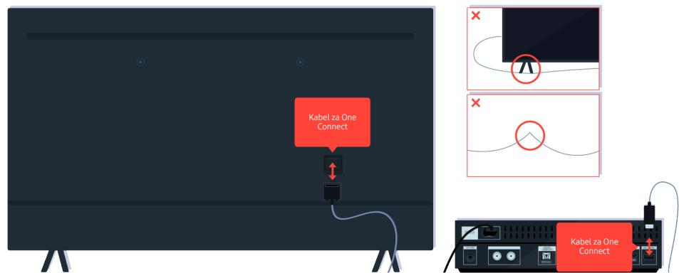
Odspojite i ponovno spojite kabel One Connect između televizora i uređaja One Connect (OC). Pobrinite se da kabel One Connect nije prikliješten ili jako savijen.
