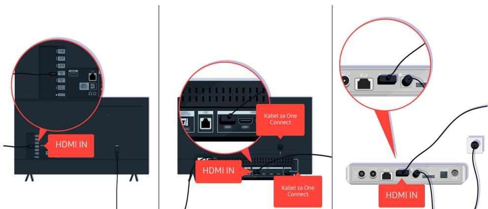
Provjerite povezanost HDMI kabela s vašim televizorom ili uređajem One Connect.
