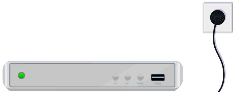
Ako se ne uključi, provjerite je li kabel napajanja ispravno povezan s uređajem i utičnicom na zidu.
