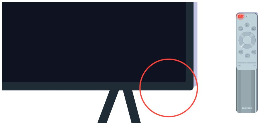
Ako se senzor daljinskog upravljača isključi kada pritisnete gumb za napajanje, vaš televizor ispravno je povezan s napajanjem.
