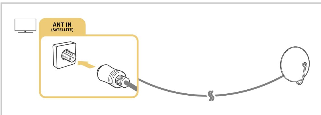
Najbolje je povezati oba priključka pomoću načina rada Multi-Switch ili DiSEqC Switch itd. pa [Vrsta antenskog priključivanja](#) postaviti na **dvostruki**.
