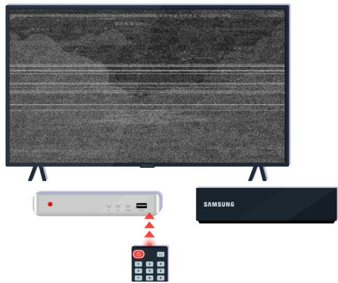
Ako upotrebljavate daljinski upravljač za više brendova (MBR) ili univerzalni daljinski upravljač i vaš upravljač ne može funkcionirati na vanjskom uređaju, pomaknite vanjski uređaj bliže uređaju One Connect.
